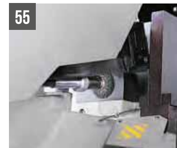
55 SHARK 332 SXI/NC 5.0 - 382 SXI Dispositivo pulilama a spazzola motorizzata
