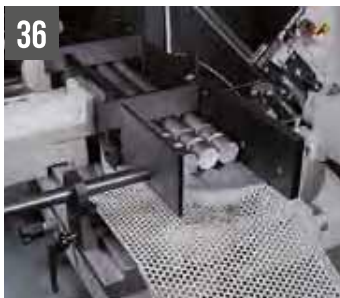
SHARK 332 NC 5.0 Dispositivo per tagli a fasci e guida regolabile scarica pezzi (max 240x90)
