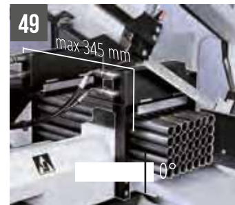
49 SHARK 281 NC 5.0 - morse verticali idrauliche per tagli a fasci (max 170x130 mm)
