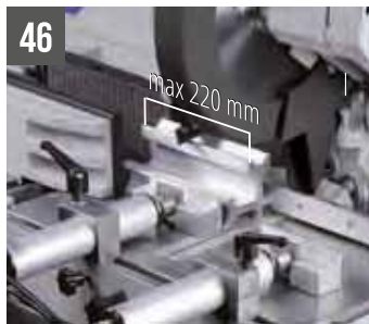
46 COBRA 352 NC 5.0 morsa speciale riduzione sfrido
