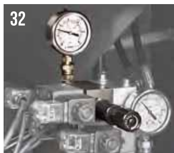
SHARK SXI evo Regolatore pressione morsa idraulica
