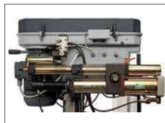
Cod. 30019: Discesa idropneumatica. Corsa mandrino automatica di 90/105 mm con ritorno rapido alla profondità impostata. Avanzamento 5÷2.500 mm/min. Potenza spinta a 6 bar: 400 Kg.
